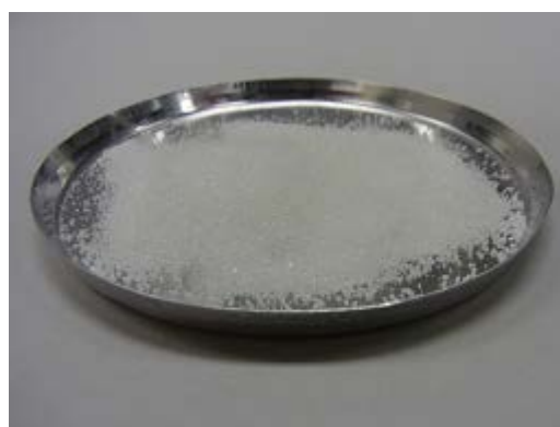
Keine Verfärbung, aber Oberfläche leicht verfestigt.
