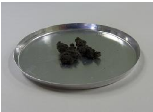
Zerbröckelte Probe auf der Schale verteilt
