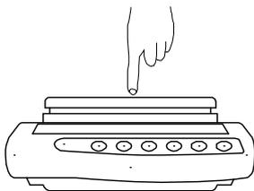
Verificare la reazione dell'indicazione di peso, premendo il piatto di bilancia con un dito.
