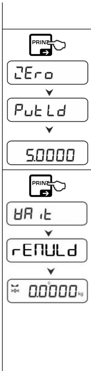
⇒ Inserire il valore del peso, per l'inserimento dei valori in forma numerica, vedere cap. 3.2.2.
