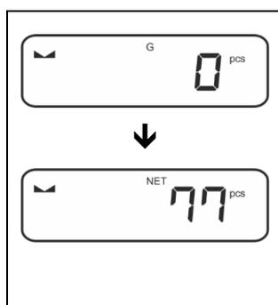
⇒ Se necessario, posizionare il contenitore usato per la pesatura ed eseguire la tara.
