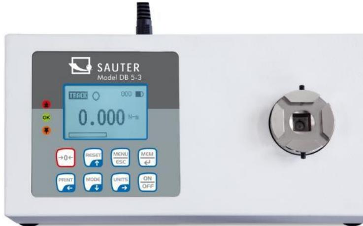
Per accendere lo strumento, premere il tasto ON/OFF. Dopo un breve autotest, il display mostra il valore di carico ammissibile in Newton.
