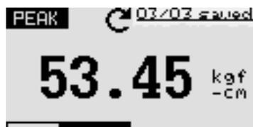
Premere i tasti freccia SU o GIÙ per cambiare la maschera di memoria. Premere e tenere premuto il tasto per scorrere fino alla posizione del cambiamento della maschera di memoria. Premere il tasto PRINT per stampare i dati memorizzati trasmessi via porta seriale. Per entrare nella maschera del menu *DELETE*, premere il tasto ZERO.
