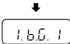
Beim Loslassen der Taste wird die erste Funktion „1.b.G.“ mit der aktuellen Einstellung angezeigt.
