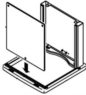
Darauf achten, dass der Befestigungspunkt am Rahmen im Loch der Frontplatte platziert ist.
