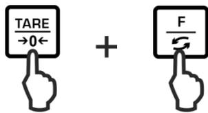
**F**-Taste und **TARE**-Taste gleichzeitig drücken und gedrückt halten bis „Func2“ angezeigt wird.
