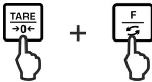
Bei gedrückter **TARE**-Taste die **F**-Taste drücken, dann beide Tasten gleichzeitig loslassen.
