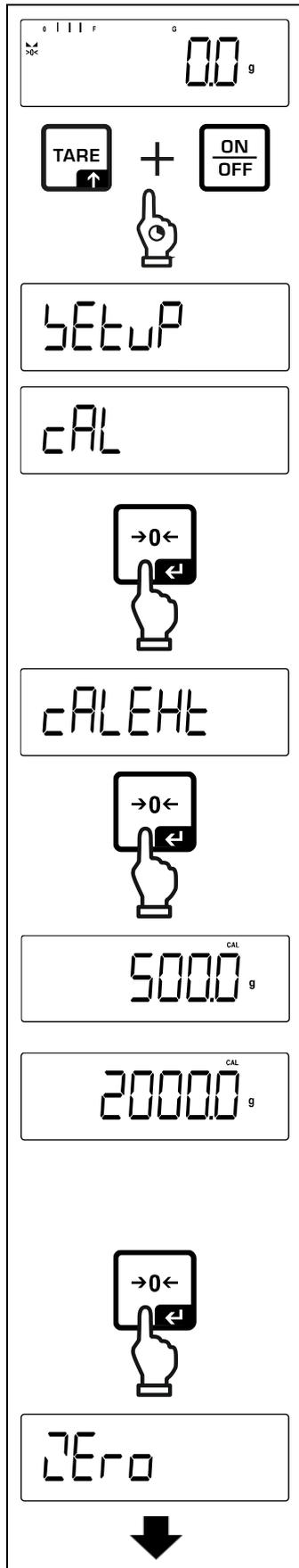
⇒ Zum Aufrufen des Setup-Menüs TARE- und ON/OFF-Taste gleichzeitig drücken und gedrückt halten.
