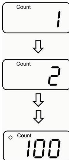
Die Anzahl der durchgeführten Pressvorgänge wird angezeigt.
