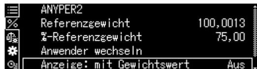
⇒ Mit den Navigationsstasten **↑**, **↓** <Anzeige mit Gewichtswert > wählen und mit **OK**-Taste bestätigen.
