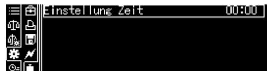
Mit den Navigationstasten Uhrzeit eingeben und mit **OK**-Taste bestätigen.
