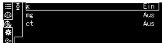
Mit den Navigationstasten **↑**, **↓** Einheit wählen und mit **OK**-Taste bestätigen.
