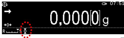
Bei aktivierter Zero tracking Funktion wird das Symbol
