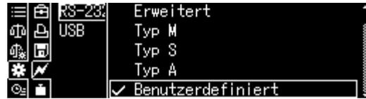
Gewünschte Einstellung mit den Navigationsstasten wählen und mit **OK**-Taste bestätigen.
