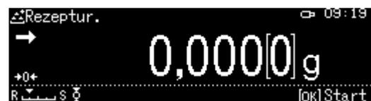
⇒ Erste Komponente einwiegen. Stabilitätsanzeige ( $\rightarrow$ ) abwarten, dann **OK**-Taste drücken. Der Wägewert wird automatisch ausgegeben und in den Summenspeicher addiert. Anschließend erfolgt die automatische Trierung. Die Waage ist bereit für das Einwiegen der zweiten Komponente.
