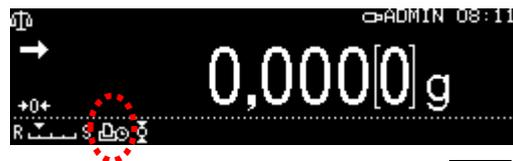
Bei aktivierter Funktion wird das Symbol
