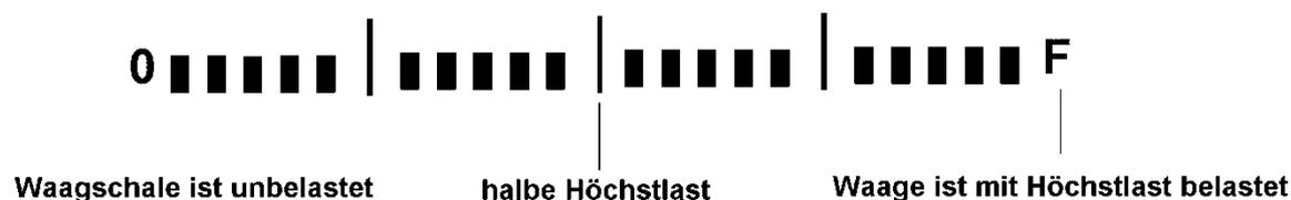
Der Wägebereich der Waage ist in 20 grafische Quader aufgeteilt. Ist kein Gewichtswert auf der Waage, so wird die Null (0) in der grafischen Anzeige dargestellt. Wird die Waage bis zur Hälfte Ihres Wägebereiches belastet, so werden 10 grafische Quader angezeigt.
